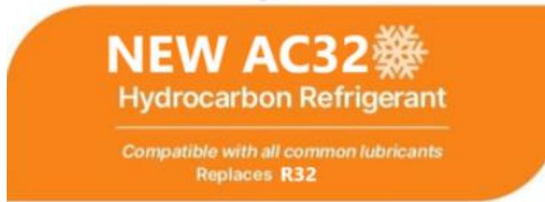
**NEW AC32 est un mélange de haute pureté composé de propane R290 et d'éthane R170, une alternative idéale aux réfrigérants synthétiques R32.**
